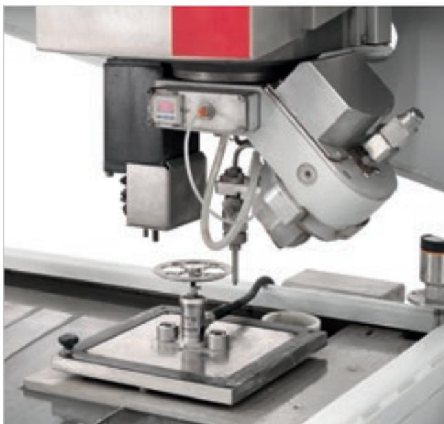
Cursor laser para definir o posicionamento da placa na base de trabalho. É possível usar o cursor laser para a coleta manual de calhas.
