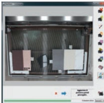
O sistema opcional de detecção fotográfico é particularmente indicado para usinagem com a máquina aberta onde é importante seguir a morfologia da pedra natural. Uma outra vantagem se refere à possibilidade de otimizar ao máximo também as placas já utilizadas parcialmente, ou otimizar as placas descartando as eventuais áreas onde há defeitos do material.
